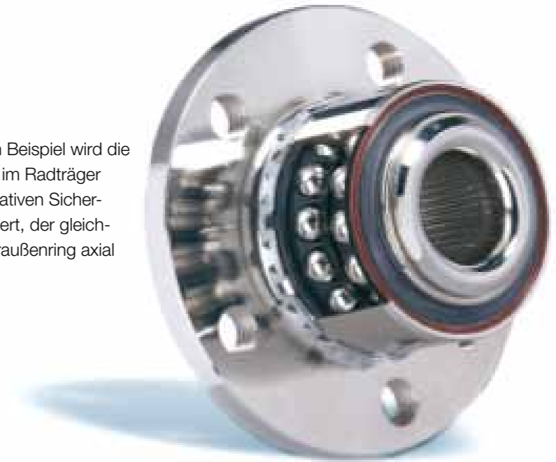
Radlagersatz 2. Generation Zum Beispiel bestehend aus: • kompakter Lagereinheit mit 2-reihigem Schrägkugellager • Achsmutter
