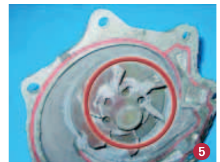
Leckagen und Schäden: Kühlmittel-Austrittsspuren an der Wasserpumpe (1), Dichtmasseeintritt in die Radialdichtung (2), mit Dichtmasse verstopfte Entlüftungsbohrung (3), Korrosion und Verkalkung durch falsches Kühlmittel-Mischungsverhältnis (4), Kavitationsschaden: das stetige Auftreffen der Flüssigkeit trägt das Material der Gehäusewand ab und beschädigt das Schaufelrad (5), Materialabtrag durch Fremdkörper wie Schleifmittel, Kalk und Rost im Kühlmittel (6). Bilder: Ruville
