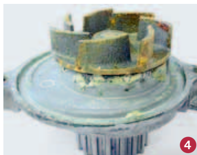
Leckagen und Schäden: Kühlmittel-Austrittsspuren an der Wasserpumpe (1), Dichtmasseeintritt in die Radialdichtung (2), mit Dichtmasse verstopfte Entlüftungsbohrung (3), Korrosion und Verkalkung durch falsches Kühlmittel-Mischungsverhältnis (4), Kavitationsschaden: das stetige Auftreffen der Flüssigkeit trägt das Material der Gehäusewand ab und beschädigt das Schaufelrad (5), Materialabtrag durch Fremdkörper wie Schleifmittel, Kalk und Rost im Kühlmittel (6). Bilder: Ruville
