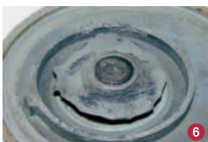
Leckagen und Schäden: Kühlmittel-Austrittsspuren an der Wasserpumpe (1), Dichtmasseeintritt in die Radialdichtung (2), mit Dichtmasse verstopfte Entlüftungsbohrung (3), Korrosion und Verkalkung durch falsches Kühlmittel-Mischungsverhältnis (4), Kavitationsschaden: das stetige Auftreffen der Flüssigkeit trägt das Material der Gehäusewand ab und beschädigt das Schaufelrad (5), Materialabtrag durch Fremdkörper wie Schleifmittel, Kalk und Rost im Kühlmittel (6). Bilder: Ruville
